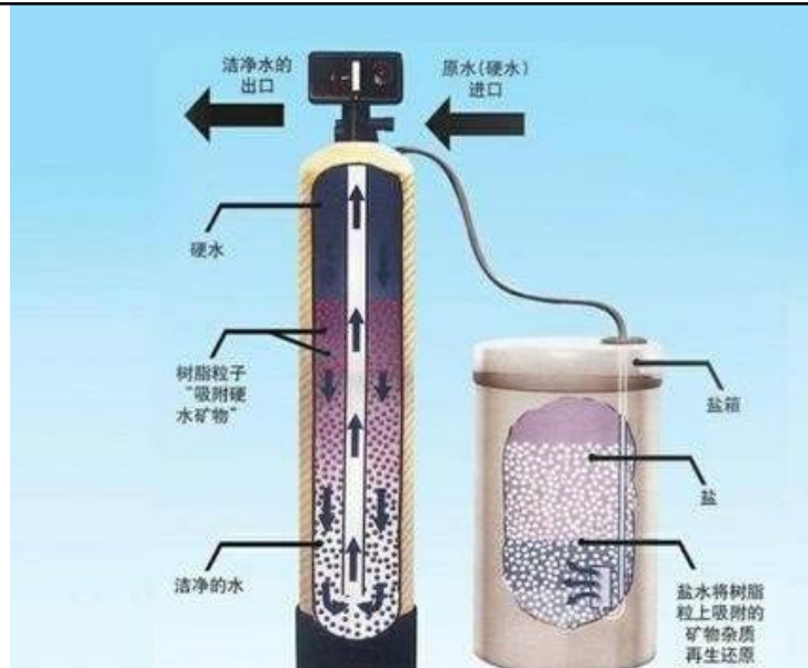
图 2-1 软水制备工艺图
