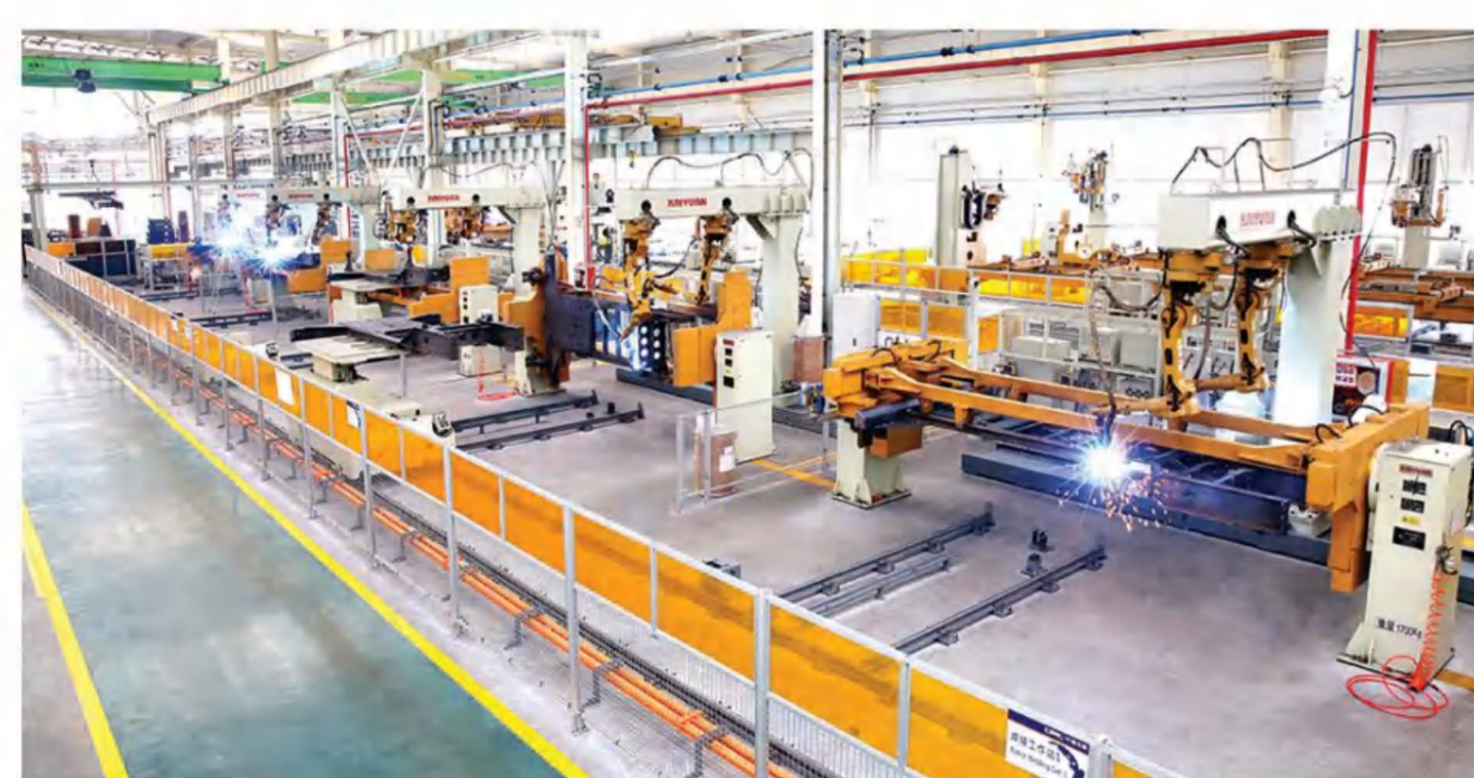
开元前车架智能化柔性焊接生产线
