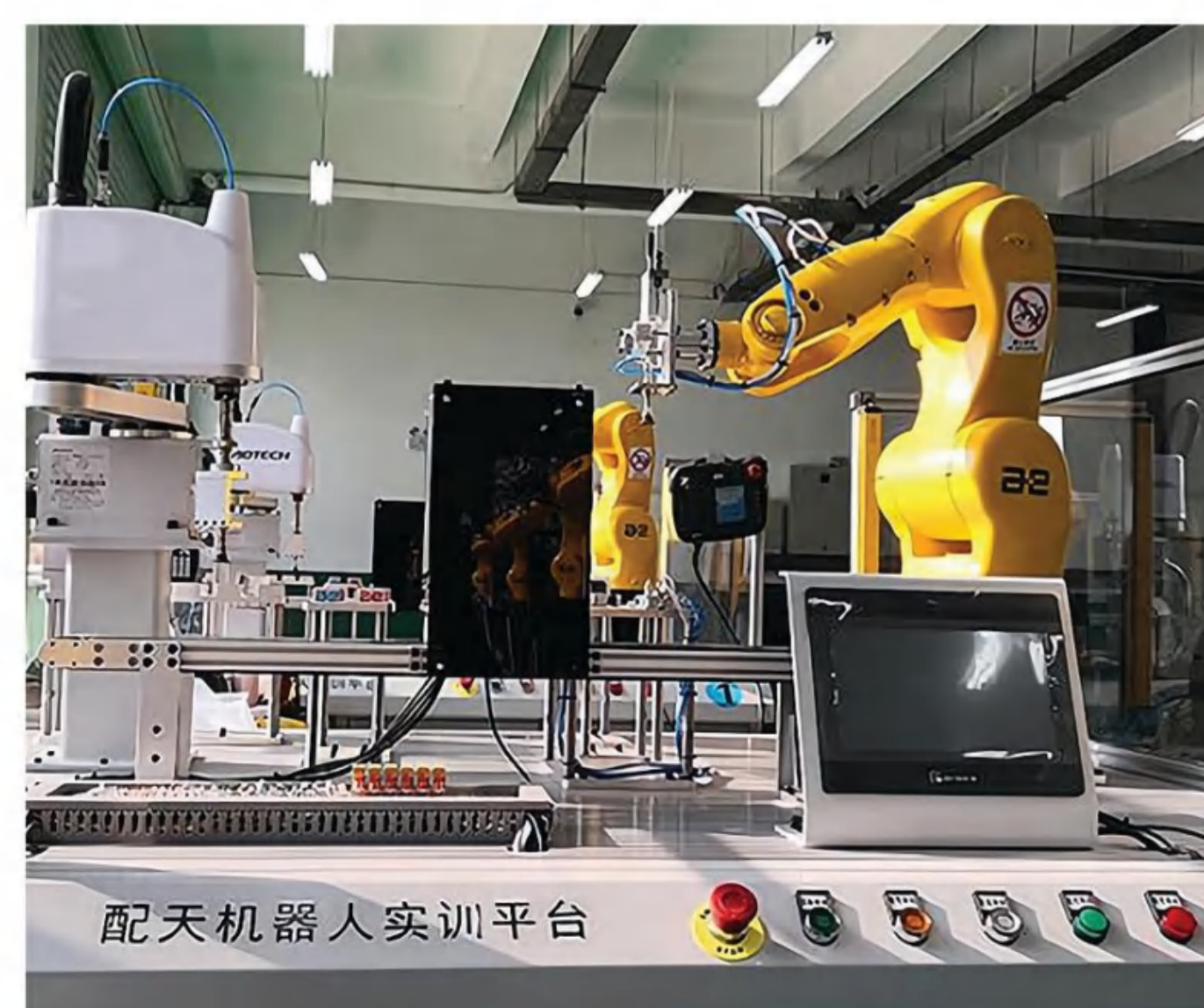
配天机器人实训平台 北京配天六轴串行通用工业机器人
