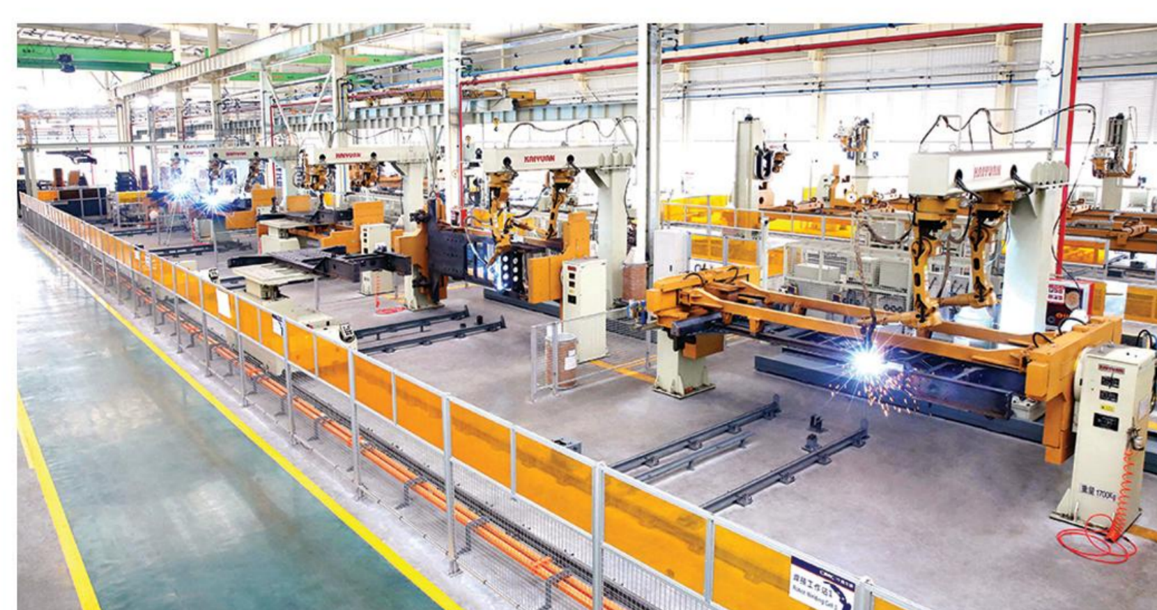
开元前车架智能化柔性焊接生产线
